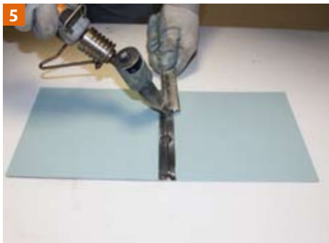
5 Puntsoldering van de te verbinden delen.
