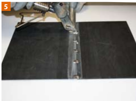
5 Puntsoldering van de te assembleren delen.
