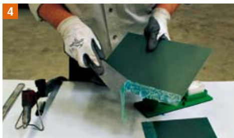
4 De blazen op de behandelde delen verwijderen met een spatel.
