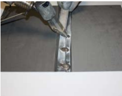
Plaatsen van de puntsolderingen
