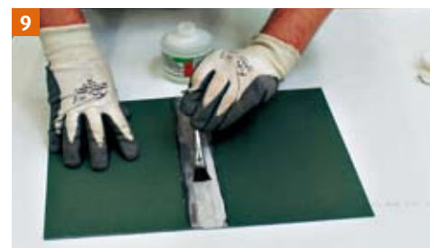
9 Breng plaatselijk ZINN7 aan om goed te kunnen solderen. Breng de 2 te solderen platen samen volgens schema p 6 - 7.
