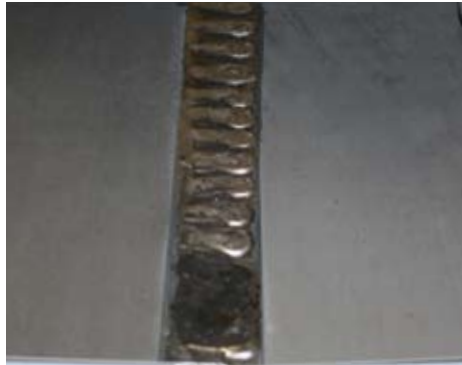
Uitsmeren van het soldeersel
