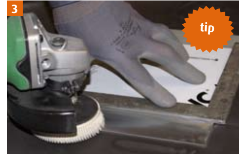
3 Gebruik een winkelhaak om een mooie rechte afwerking te bekomen.
