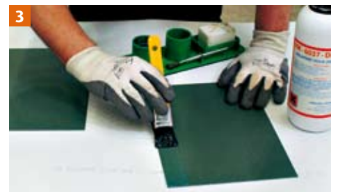
3 Behandeling van het gepigmenteerde oppervlak met DECALAQ, laat het enkele seconden inwerken.
